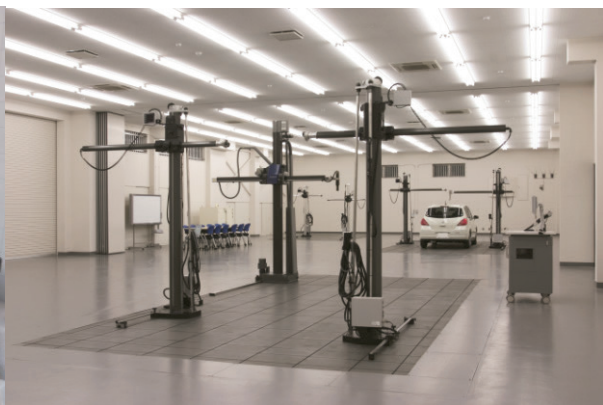
図 2 フルサイズモデル製作用の設備
