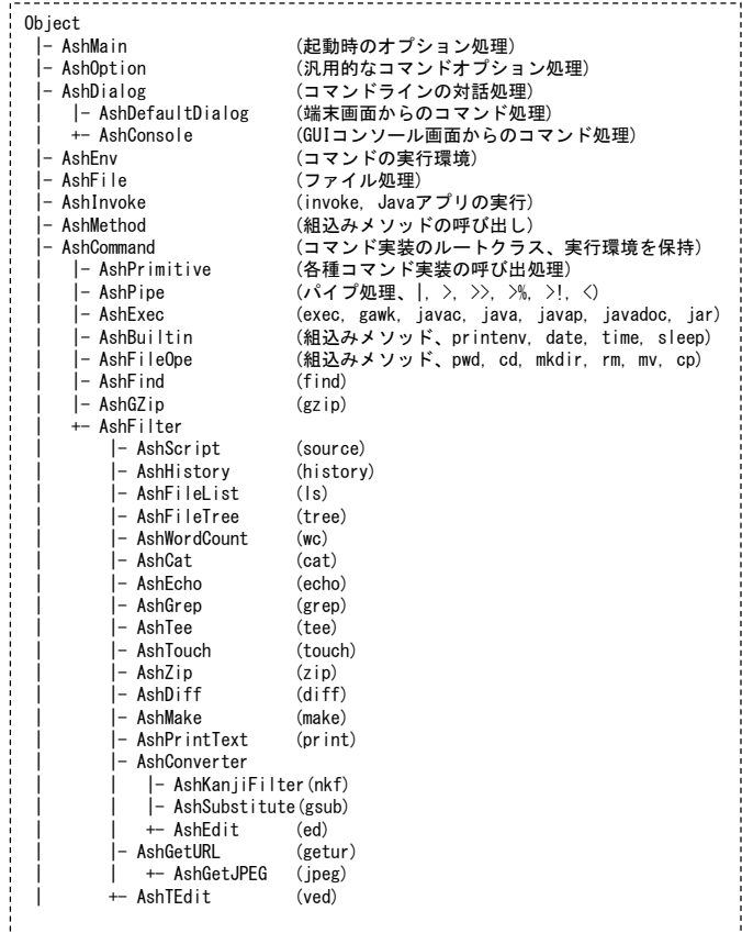
図1 Ash フレームワークを構成する主要クラス
