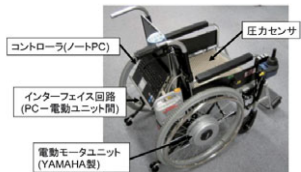
図2 開発した電動車椅子
