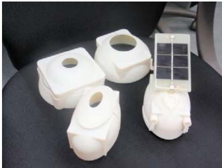
図 15 研修 C での作製例 (RP モデル)
