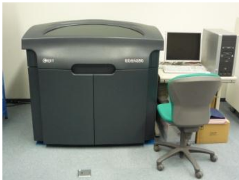
図 5 積層造形による RP 装置
