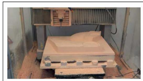
図 6 小型加工機でのケミカルウッドでの加工
