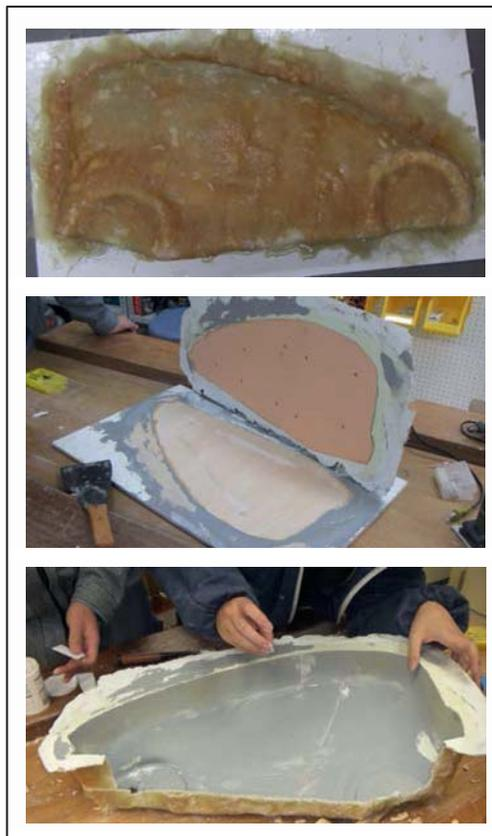
図 10 雌型製作風景
