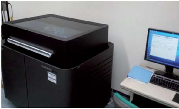
図 10 光造形機 (Objet 社 Connex350)
