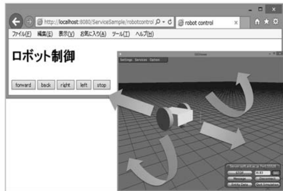
図 9 RSNP シミュレーターの画面：ブラウザ上の操作ボタンより前後左右の動作を実現している
