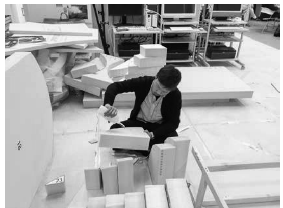
図 12: 100 mmピッチの断面形状の貼り合せ
