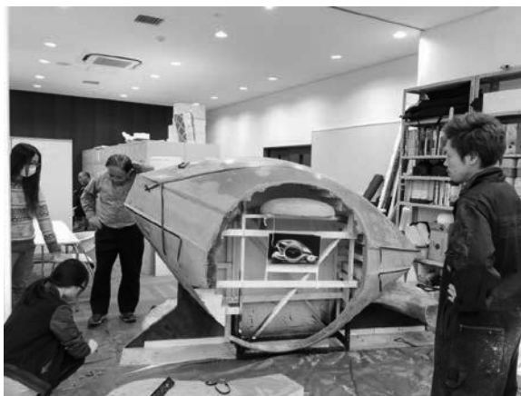
図 20: クレイ盛り付け作業風景
