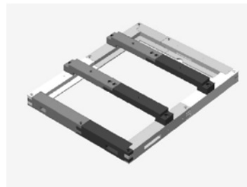
図 9 展示用タブレットフレームの OpenSCAD の表示。色が変わっている部分が分割した部品
