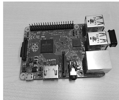
図 4 Raspberry Pi2 ボード
