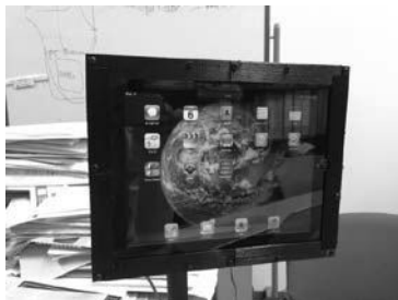
図 8 3D プリンター Da Vinci 1.0 で試作した
