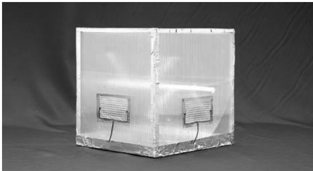
図 15： 試作機 攪拌槽
