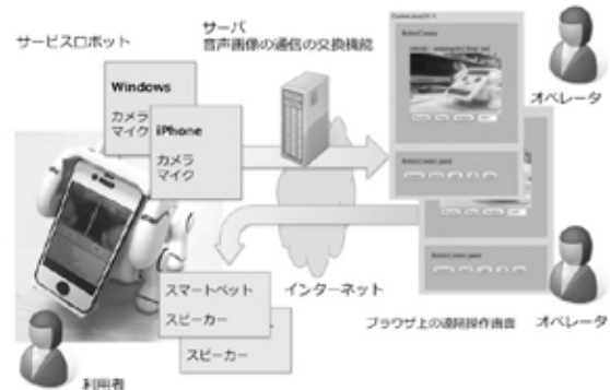
図 2: 音声通信機能をもつロボットシステムの構成
