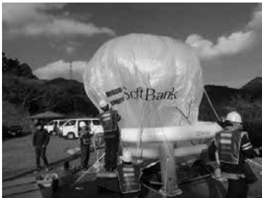
図 6: バルーンを使ったソフトバンクの臨時基地局 ([7]より転載)
