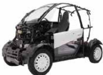
図 4: MC-β のパイプフレーム構造 [3]
