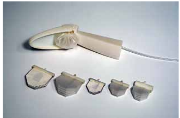
図6: 蛇腹構造の空気圧アクチュエータの試作群(手前) 実装した腕部の試作(奥)
