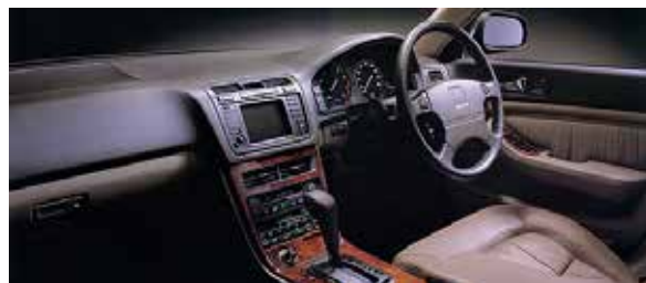
図 15: 1990 ホンダ レジェンド (インパネに一体化されたナビゲーションシステム)
