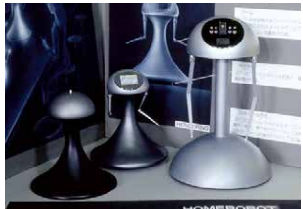
図 1: 早稲田大学、パフォーマンス・ロボット(1986年)[5] 左から、イメージモック、モックアップ、動作試作
