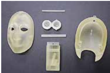
図 6: 光造形型 3D プリンタで印刷した「かしら」部品
