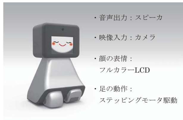
図 6 : UCR-02 構成図[11]改変
