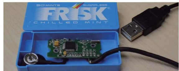
図 3: FRISK ケースに内蔵されたマイク. 音声入力を効果的に行うためにアンプ等を組み合わせる。
