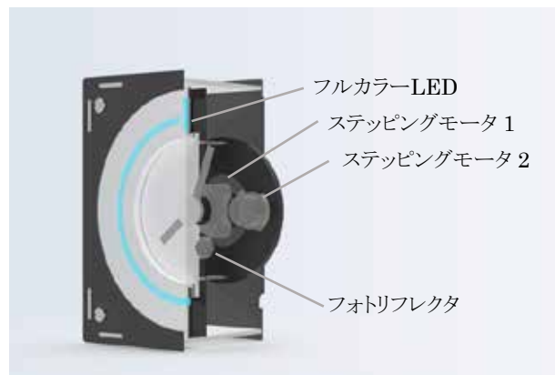
図 7: UHR-01 機構構成図
