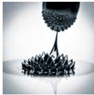
図 8: 磁性流体のスパイク現象
