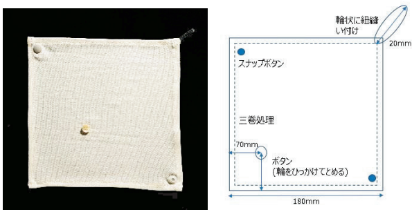
図 10: 代替ラップの試作品と図面
