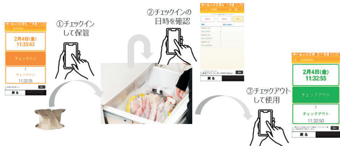
図 11 :NFC による保管履歴管理システム
