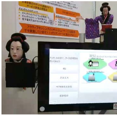
情報の集約 とアンケートシステムに接続したコミュニケーションロボット(かしらロボ)と(浄瑠璃ロボ) 人検出センサシステム
