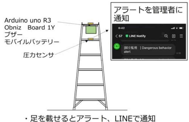
図 3 誤った使用法の検知と通知方法概略
