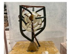
③ 湯口・湯道の取付
